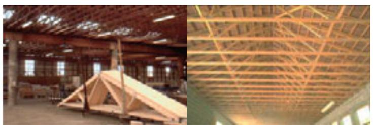
Très utilisé dans les constructions d'aujourd'hui, le système d'assemblage des bois par connexion (utilisation de connecteurs sous presse) permet la réalisation de « fermettes » bois destinées à la réalisation de charpente. En apportant votre plan à votre distributeur **Bâtiland**, nous vous proposons de réaliser l'étude technique et le chiffrage de votre charpente.
